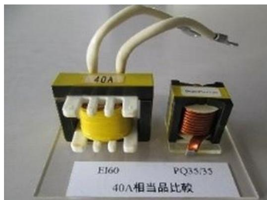
フェライトコアと平角線により高周波／大電流で使用可能なパワーインダクターです。抵抗値が低い為、温度上昇が小さく線積率が大きいので高効率で使用できます。
